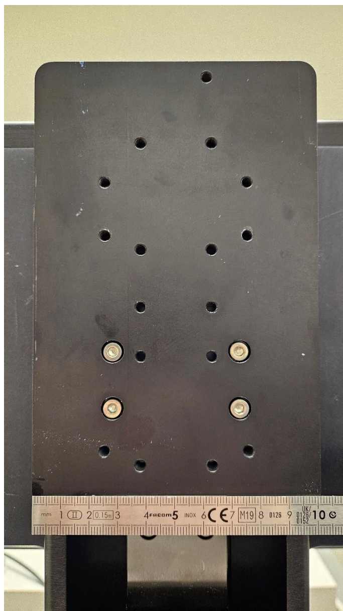
Platine pour fixation du microscope sur le pont optique 16 trous taraudés US 9/64
